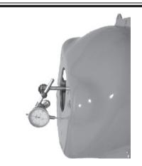
NEXT, THE BELLHOUSING FACE SHOULD BE CHECKED FOR PARALLELISM TO THE BACK OF THE BLOCK. INSTALL THE INDI-CATOR (AS SHOWN ABOVE). ROTATE THE CRANKSHAFT AND MARK DOWN THE READ-INGS (BE SURE TO PUSH THE CRANKSHAFT AGAINST THRUST BEARING FOR ACCURATE MEASUREMENT). THE MAXIMUM OUT OF PARALLELISM IS .002"
