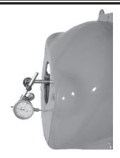
NEXT, THE BELLHOUSING FACE SHOULD BE CHECKED FOR PARAL-LELISM TO THE BACK OF THE BLOCK. INSTALL THE INDICATOR (AS SHOWN ABOVE). ROTATE THE CRANKSHAFT AND MARK DOWN THE READINGS (BE SURE TO PUSH THE CRANKSHAFT AGAINST THRUST BEARING FOR ACCURATE MEASUREMENT). THE MAXIMUM OUT OF PARALLELISM IS .002"
