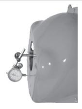
NEXT, THE BELLHOUSING FACE SHOULD BE CHECKED FOR PARALLELISM TO THE BACK OF THE BLOCK. INSTALL THE INDICATOR (AS SHOWN ABOVE). ROTATE THE CRANKSHAFT AND MARK DOWN THE READINGS (BE SURE TO PUSH THE CRANKSHAFT AGAINST THRUST BEARING FOR ACCURATE MEASUREMENT). THE MAXIMUM OUT OF PARALLELISM IS .002"
